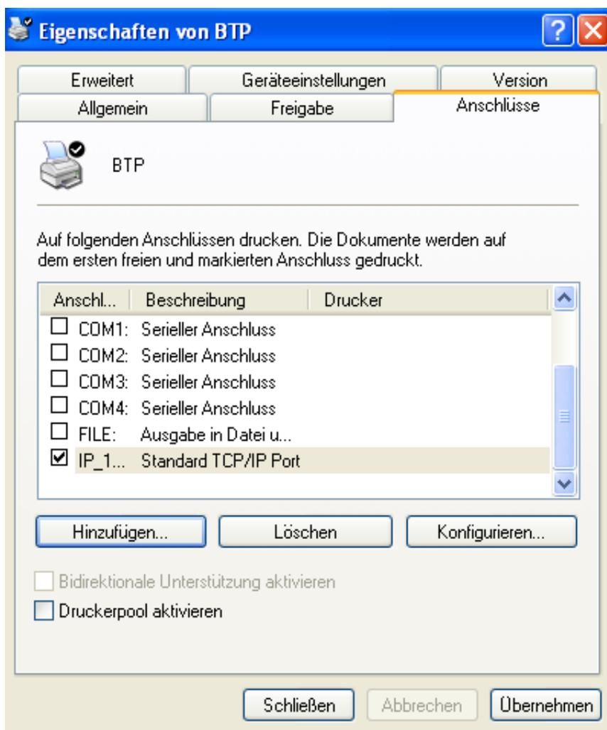
Nun ist der Netzwerkanschluß in der Auswahl verfügbar. Wählen Sie den Anschluß IP\_1... aus (eben so, dass dort ein Häkchen ist) und wählen Sie den Anschluß LPT1 ab. (kein Häkchen).
